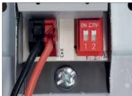
Dip switch per la selezione della corrente in uscita Equipped with dip switch for selection the output current
