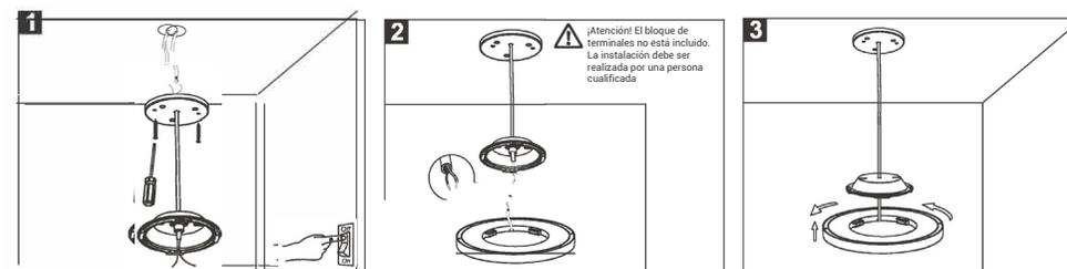
1. Apaga el interruptor. Use tapas de terminales para conectar la línea de entrada de placa de metal con el cable de alimentación. Atornille la placa de metal en la imagen al techo.
